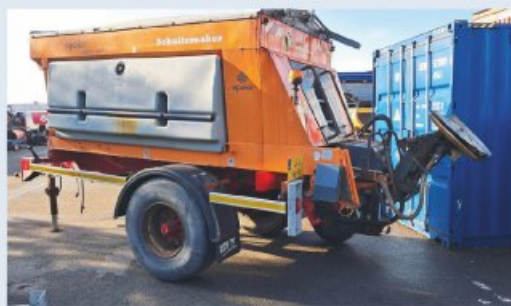
Posypywarka do traktora Epoke SH3800 Rok produkcji 2010 Pojemność 5m3 Sterowany Zdalnie
