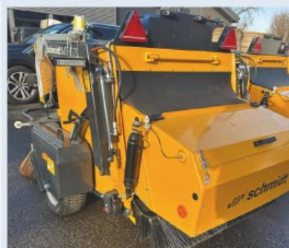
SCHMIDT MSH070 Rok produkcji 2021 Poj. zbiornika 700l Szer. zamiatania 1600-1900mm Napęd hydrauliczny prze WOM pojazdu holującego zdalne sterowanie
