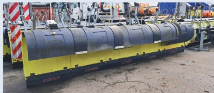
NIDO ML51A Rok Produkcji 2005 Szerokość całkowita 410cm do 510cm Sterowanie zdalne, elektrohydrauliczne
