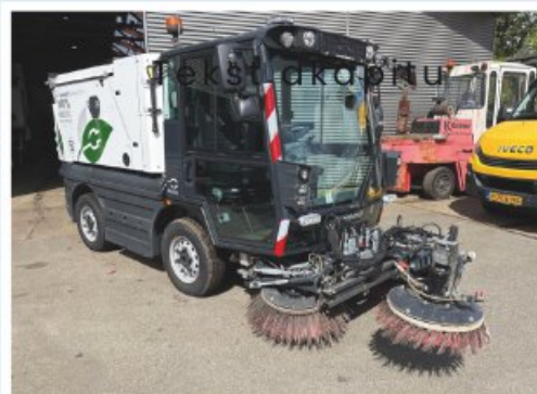
SCHMIDT ESWINGO Rok produkcji 2021 100% elektryczna, 0% emisji Akumulator 75 kWh 3 szczotki
