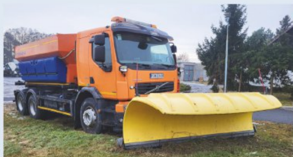
Volvo FE 340 + Schmidt Stratos B90-42 VCLN + Schmidt SNK34. Rok produkcji 2010
