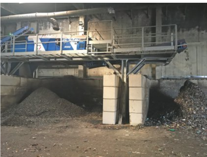
Przesiewacz Hexact 4000, stabilizat 0/80 mm na sicie o dyskach 20 mm.
