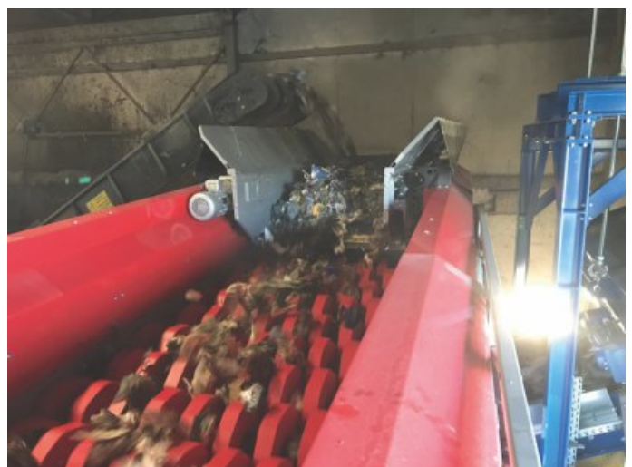
Przesiewacz Hextra 6000, zmieszany odpad komunalny po rozdrabniaczu wstępnym na sicie o dyskach 80 mm.
