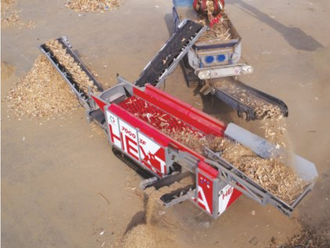
Przesiewanie odpadów drewnianych w obiegu zamkniętym z nawrotem frakcji nadситowej do rozdrabniacza.
