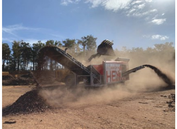
Przesiewacz Hextra 5000 z przenośnikiem frakcji drobnej skierownym na lewą stronę podczas siania kompostu.
